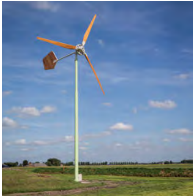
Groningse houten windmolen van EAZ Wind, 12 m hoog
