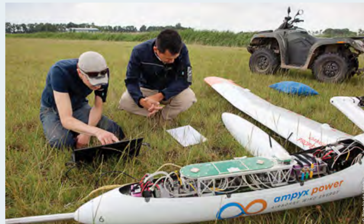
Ampyx Power ontwikkelt vliegtuigjes om duurzame energie mee op te wekken. Dit gebeurt hoog in de lucht waar meer wind is. Ze zijn vrijwel geluidloos.
